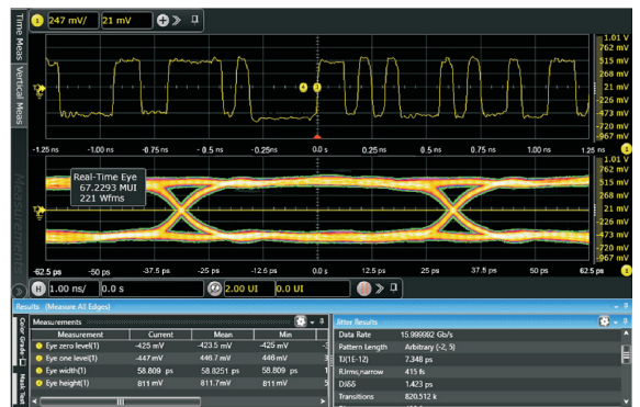
图 14 16 Gb/s PRBS7 输出数据差分眼图测试结果截屏 Fig. 14 16 Gb/s PRBS7 output data differential eye diagram test results
